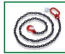
Artikel-Nr.: 211308 Rückekette 8 mm, 3 m lang zul. Zugkraft 4 t Bruchlast 8 t
